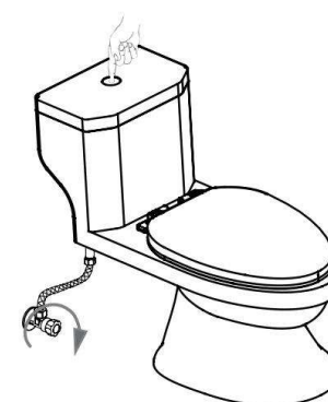
1. Zamknij dopływ wody spłucz toaletę, aby opróżnić zbiornik
