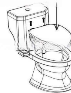
4. トイレトンシツの設置
