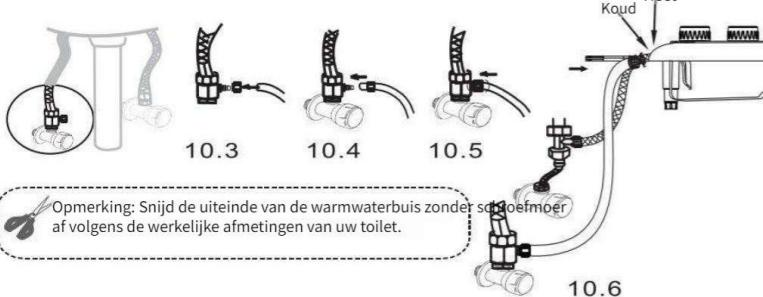
Draai de duimmoer los van de warmwateradapter
