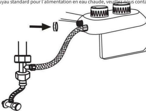
Le bidet fonctionnera également avec de l'eau froide uniquement si vous ne souhaitez pas raccorder l'arrivée d'eau chaude, vous n'avez besoin que de l'accessoire que nous proposons dans ce cas : Entrée d'eau chaude
