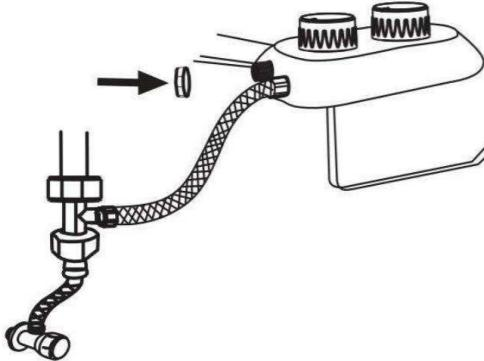
Das Bidet funktioniert auch nur mit kaltem Wasser, falls Sie den Warmwasseranschluss nicht anschließen möchten. Sie benötigen in diesem Fall nur das von uns angebotene Zubehör: Warmwasserzulauf.
