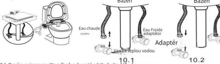
10.1: Prosím, nejprve zavřete prívod vody, poté odsáhejte adaptér teplé vody v umyvadle vlastníma rukama
