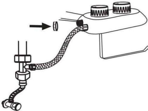
Das Bidet funktioniert auch nur mit kaltem Wasser, falls Sie den Warmwasseranschluss nicht anschließen möchten. Sie benötigen nur den
