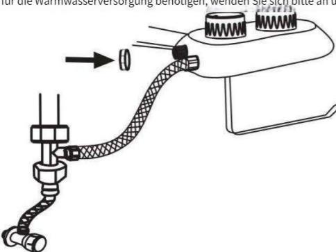
Das Bidet funktioniert auch nur mit kaltem Wasser, falls Sie die Warmwasserversorgung nicht anschließen möchten, sondern nur das benötigen.
