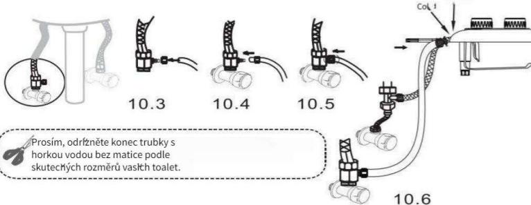
10.5: Pevně utáhněte křížkovou matici na adaptér teplé vody, abyste chránili spojovací díl.
