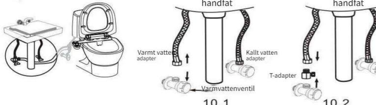
Stäng av vattenförsörjningsventilen först och skruva sedan loss handtaget för varmvatten i handfatet.
