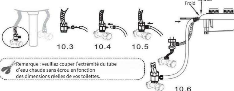
10.3 : Dévissez l'écrou à oreilles de l'adaptateur d'eau chaude
