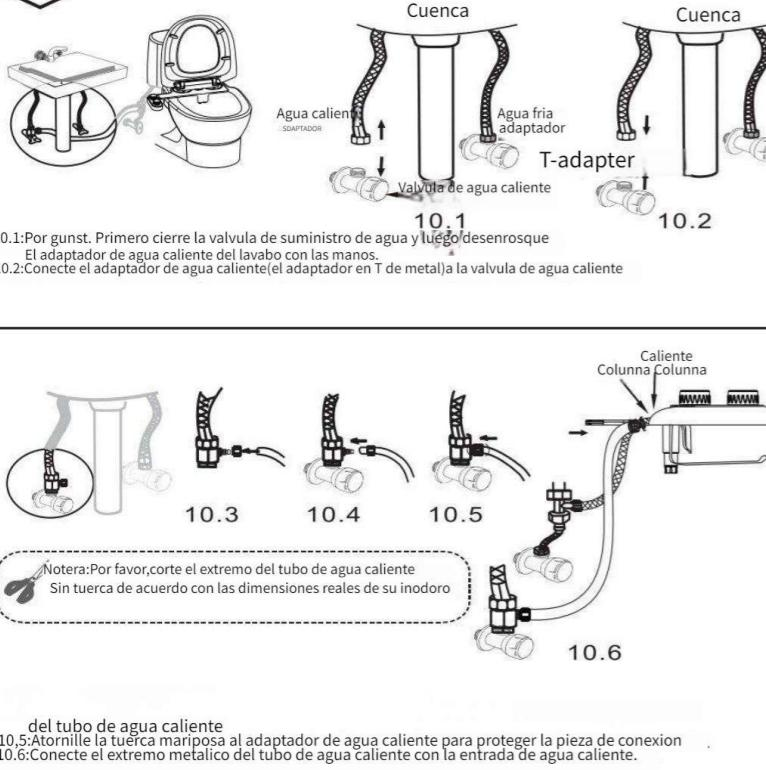
10.5: Atornille la tuerca mariposa al adaptador de agua caliente para proteger la pieza de conexión
