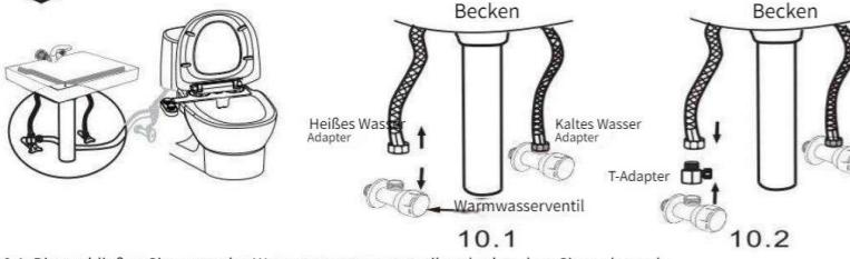
10.1: Bitte schließen Sie zuerst das Wasserversorgungsventil und schrauben Sie es dann ab
