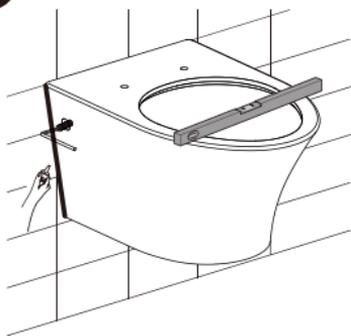
将坐便器后端安装孔对准墙上的定位柱后插入，然后用内六角扳手将紧固螺钉拧进两侧安装孔。调节坐便器水平并锁紧螺钉，并在与墙接触的边沿涂抹中性防霉硅胶以填平接触面的缝隙。
