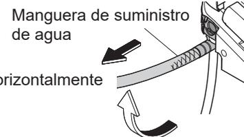
(3) Después de vaciar el agua, instale la válvula de vaciado del filtro de agua y la cubierta.
